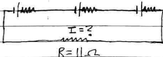
$$R_{TOT} = r_1 + r_2 + r_3 + R = 3\Omega + 3\Omega + 3\Omega + 11\Omega$$
